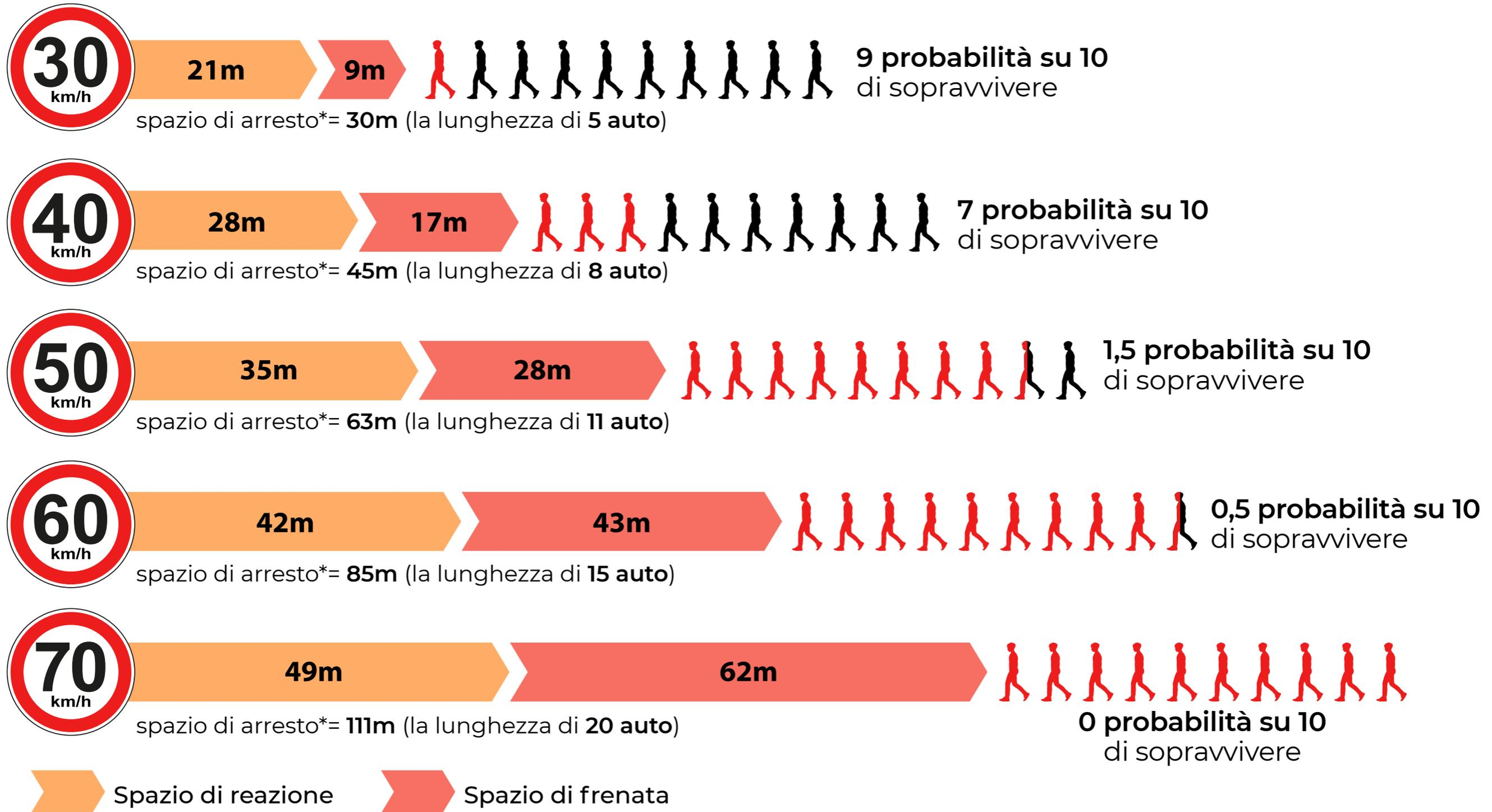
\*Spazio di arresto in condizioni di asfalto bagnato; lunghezza singola vettura=5,6m
